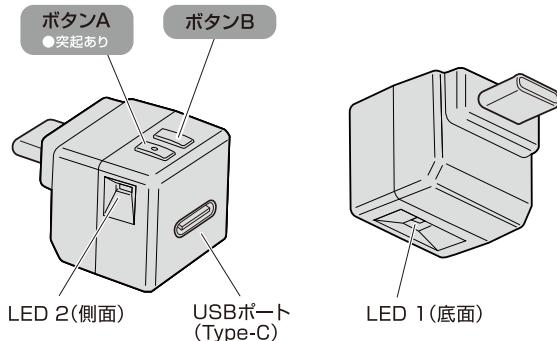
※上図の各部の位置は接続する電源側のUSBポートが横向きの場合
